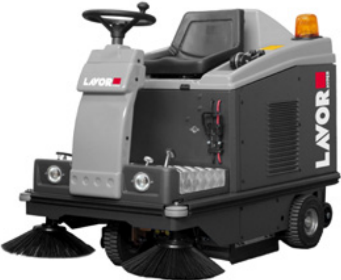
▲ KS-4 1101B Nagy teljesítményű ráúlós seprőgép elektromos szűrőrázóval és nagy méretű szűrővel. Elektromos indítás, állítható főkefe, akkumulátor töltöttség kijelző, automata akkutöltő, első lámpa.
