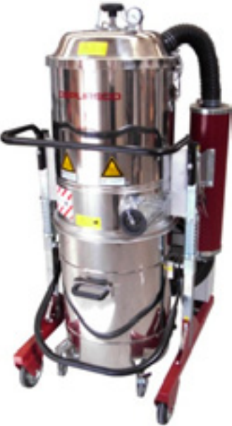
RAM Olajleszívó egység nagy tartállyal, beépített szűrővel és komplett tartozékszettel.
